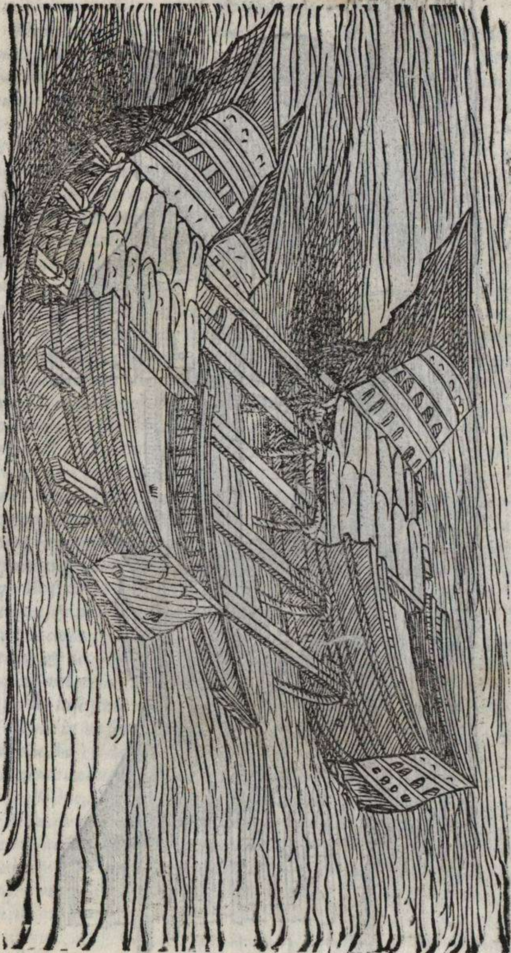
Figural esempio delle due navi plene di acqua, per sollevare la nave affondata.
