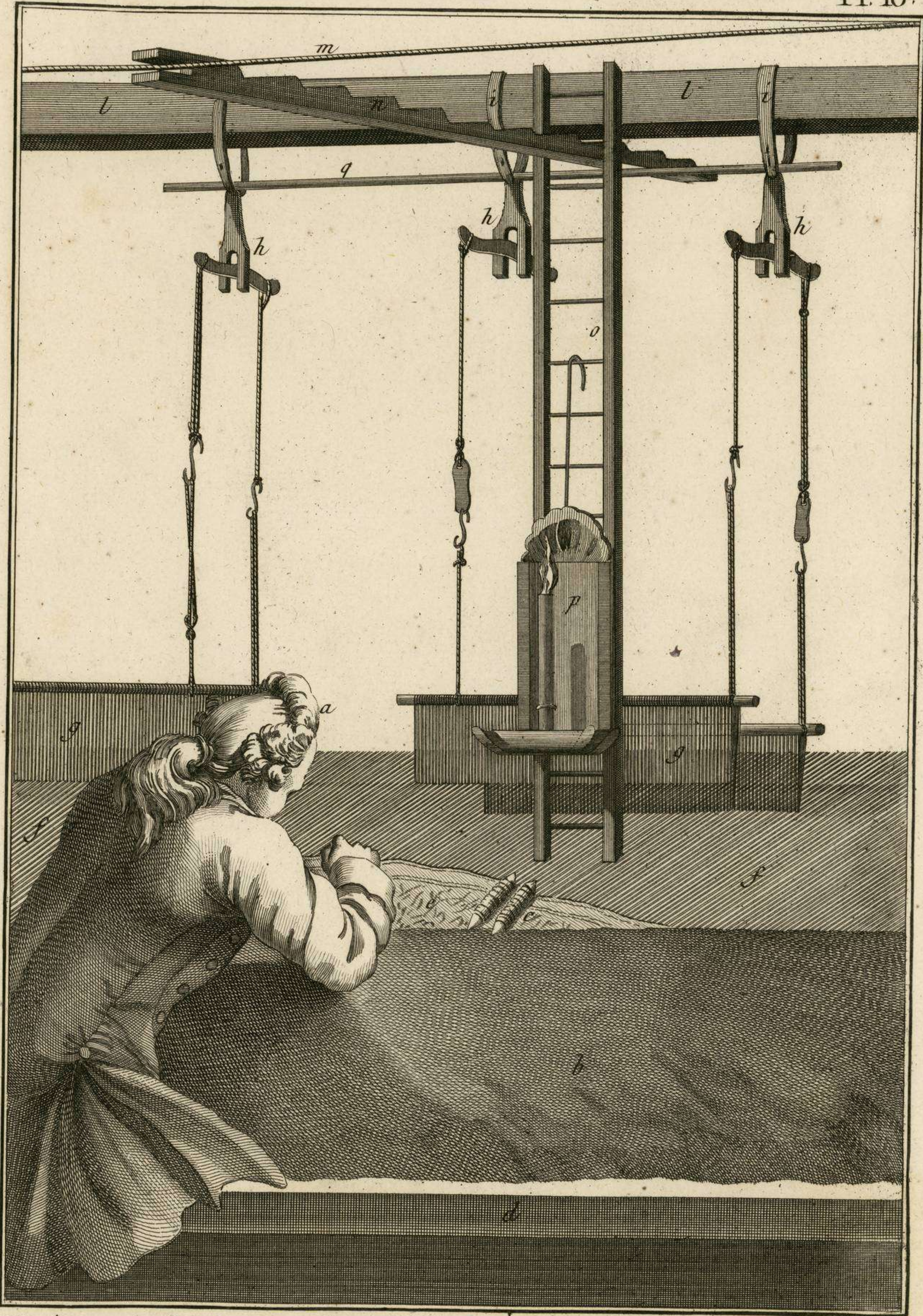
Tapissierie de Basse Lisse des Gobelins, ouvrier qui travaille à la lumière
