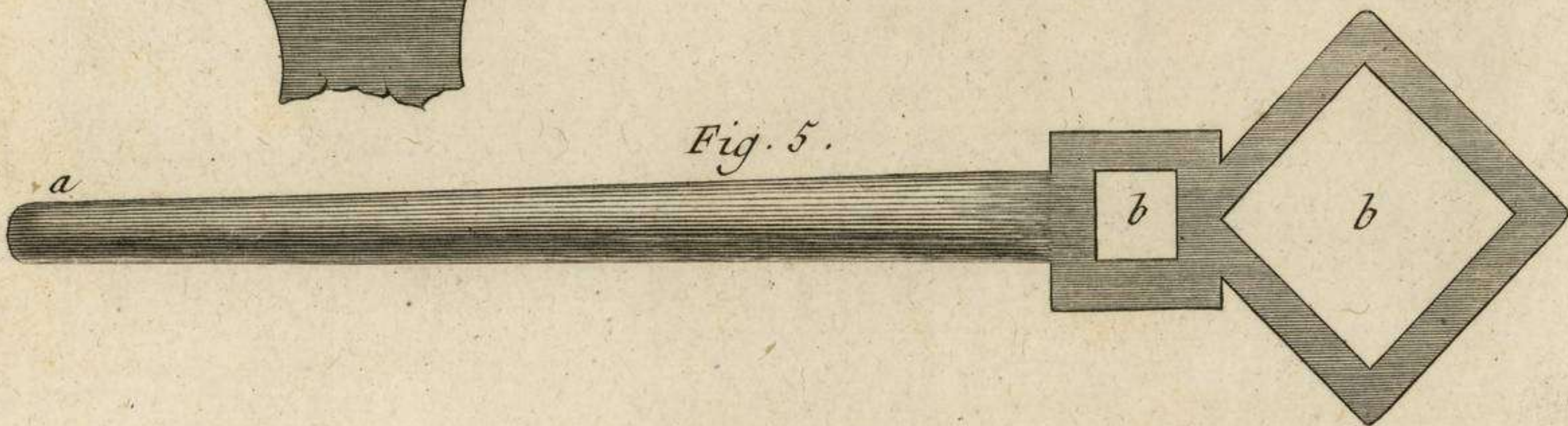
Tapissierie de Basse Lisse des Gobelins. Coupe de la Vis de la Jumelle et Développemens.
