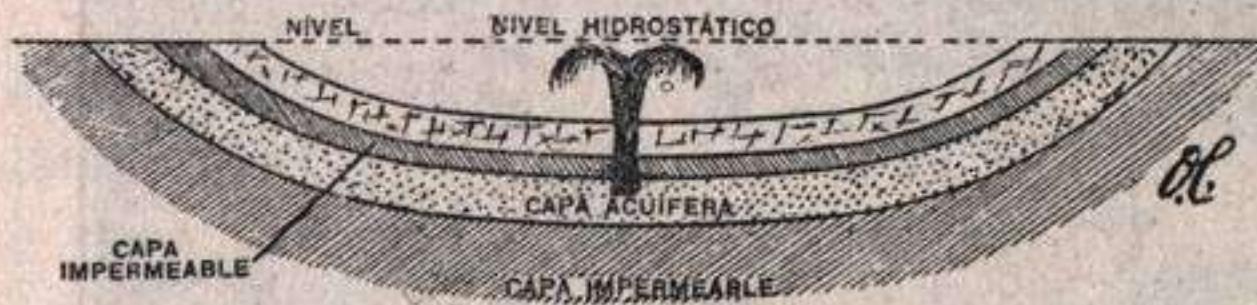
Fig. 331.—Esquema de un pozo artesiano.
