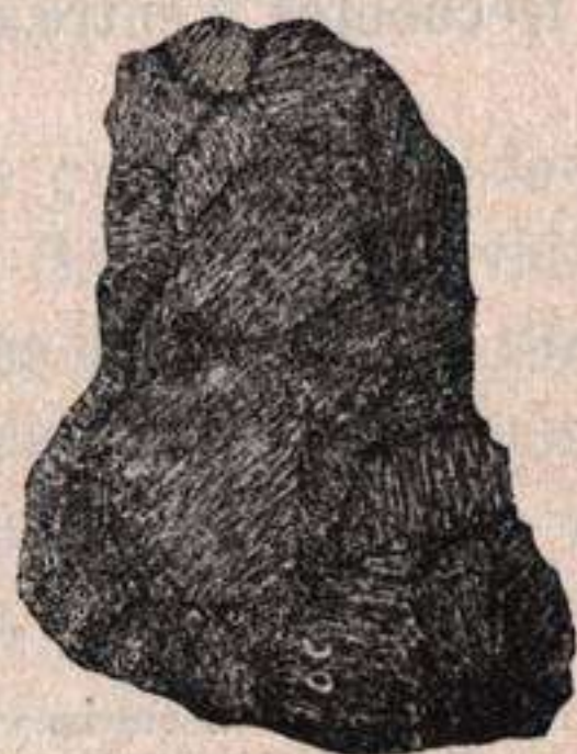
Fig. 138.—Estructura espática de una broncita: se aprecian bien las distintas hojas, porque éstas poseen finas estrias dirigidas en direcciones diferentes para cada hoja. (Fot. O. Cendrero).
