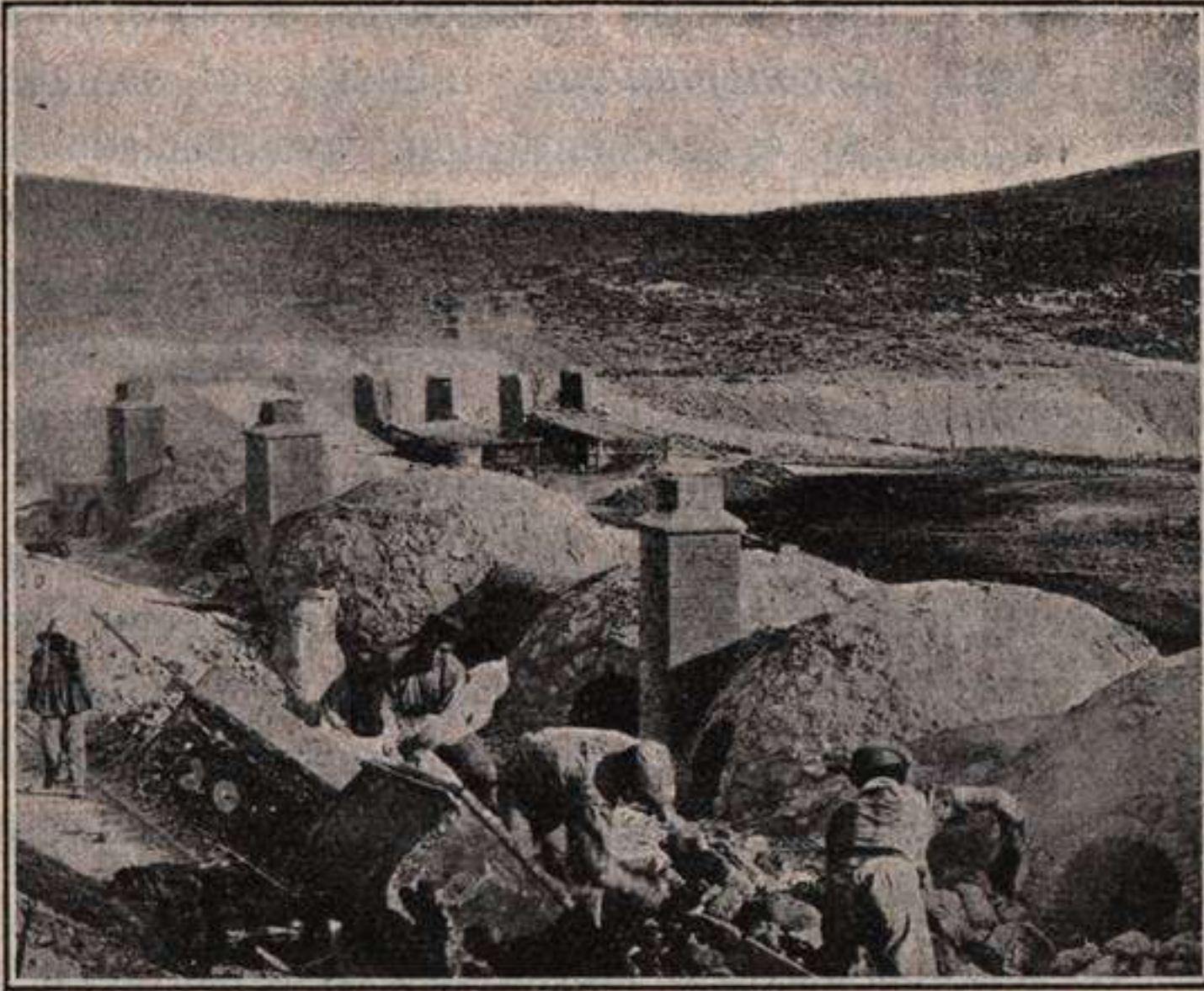
Fig. 193.—Minas de azufre de Libros (Teruel).—Cargando los hornos de primera fusión con las margas azufrosas. (Fot. comunicada por el Dr. J. Pueyo Ledesma).
