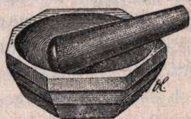
Fig. 177.—Mortero de ágata. (De la obra Prácticas de Mineralogía y Geología , por J. Royo y Orestes Cendrero).
