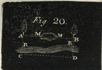
Se tira con la escuadra la línea recta CD; desde los puntos C y D se levantan dos perpendiculares, la una hácia A, la otra hácia B, y se mide la línea CD. Su longitud será precisamente igual á la distancia del punto A al punto B. Sea para medir el terreno triangular ABC (fig. 21)
