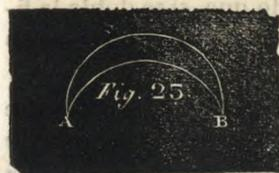
6. **Media-luna.** Esta figura se compone de dos arcos, que pasan por dos puntos comunes A y B, y están trazados desde dos centros tomados sobre una línea perpendicular á la recta, que une los puntos A y B (fig. 25).
