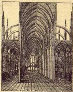
Fig. 233.—Sección transversal perspectiva de una iglesia gótica (San Ouen en Ruán); siglo XIV.
