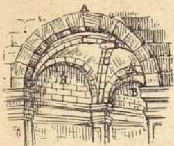
Fig. 59.—Arcos formeros, transversales y cruceros.
