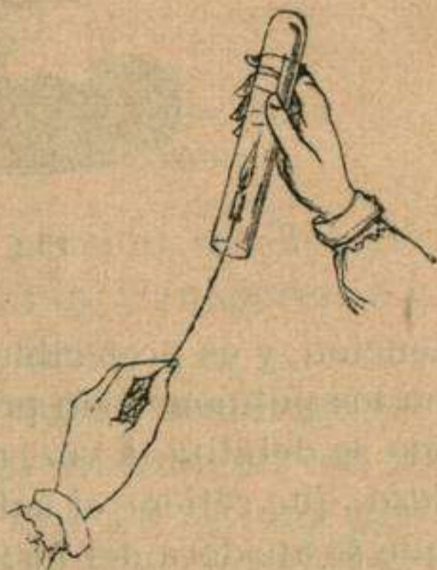
Fig. 12.—Reconocimiento del hidrógeno.
