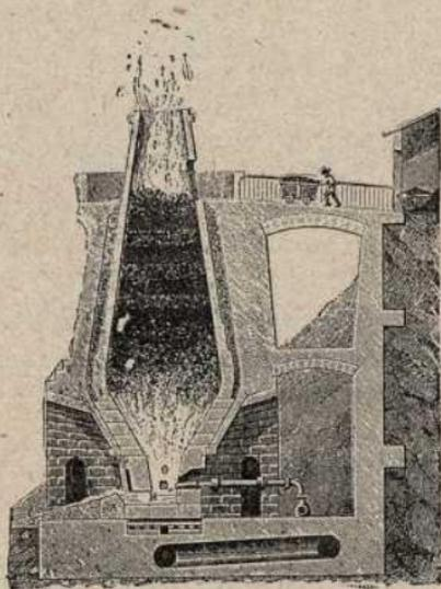
Alto horno para la fundición de metales
