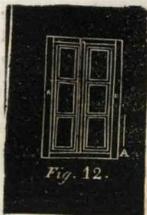
16. **Ventana de seis tableros, etc.** Se tirará una línea, dos ó tres veces mayor que A; se levantará una perpendicular que tenga con la primera la misma relación que D con A; fórmese el bastidor A BCD y la armazon E; finalmente, háganse las tres divisiones de la altura y las dos de la base, y quedará representado lo restante de la ventana. (fig. 12).
