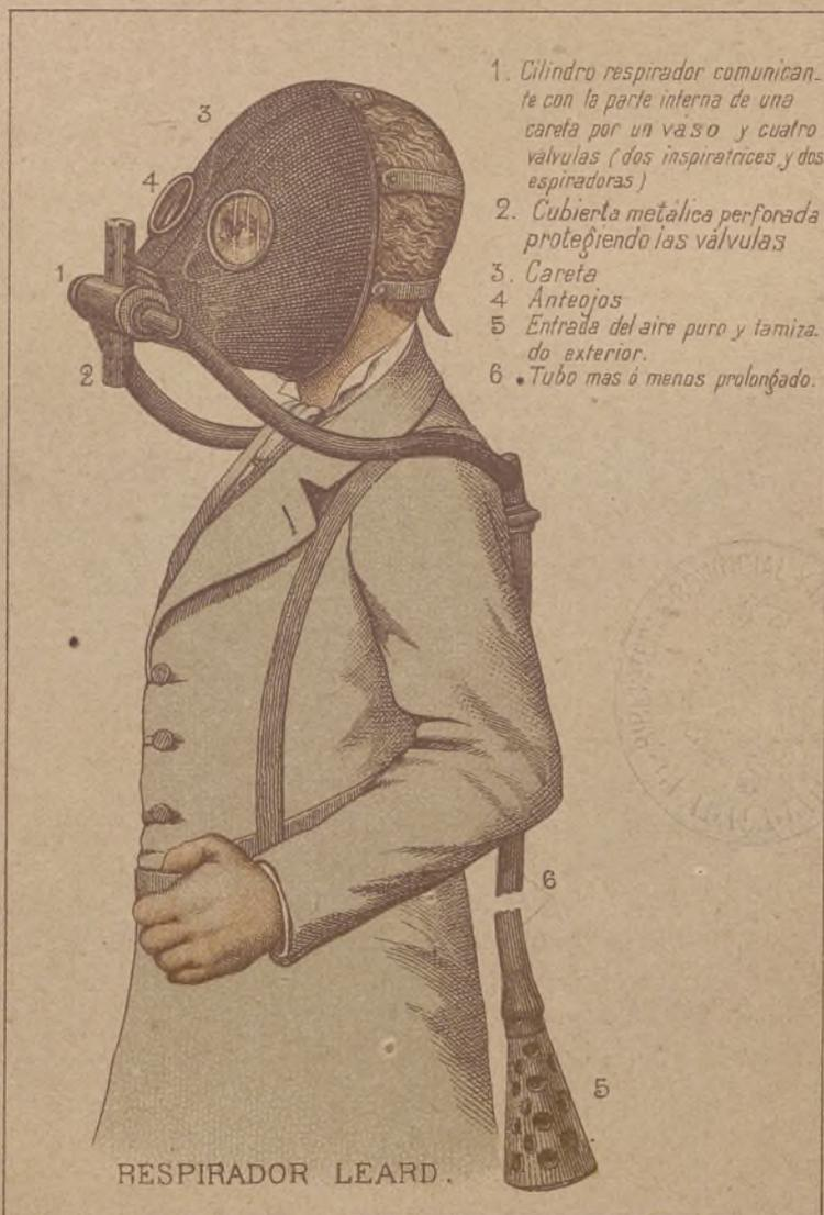
1. Cilindro respirador comunicante con la parte interna de una careta por un vaso y cuatro válvulas (dos inspiratrices y dos espiradoras)
