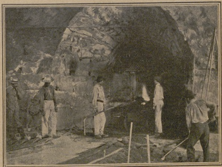
LA METALURGIA MINERA.—Boca del alto horno de la Usina Esperanza. La fundición está lista. Los obreros espuman las últimas escorias. En el suelo pueden verse los canales de tierra refractaria prontos para recibir el metal en fusión. El ingeniero Queiroz (á la izquierda del grabado), dirige la operación, no exenta de riesgo.
