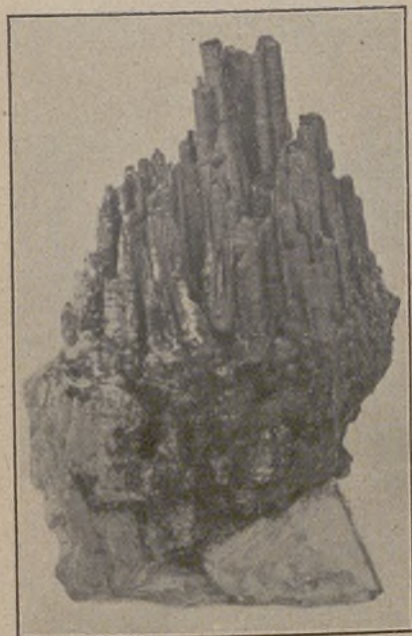
Limonitas, de alto tenor mineral, que se presentan en formas tubulares del más curioso efecto. Todo esto abunda en cerros enteros, facilitando la extracción económica del mineral de hierro.
