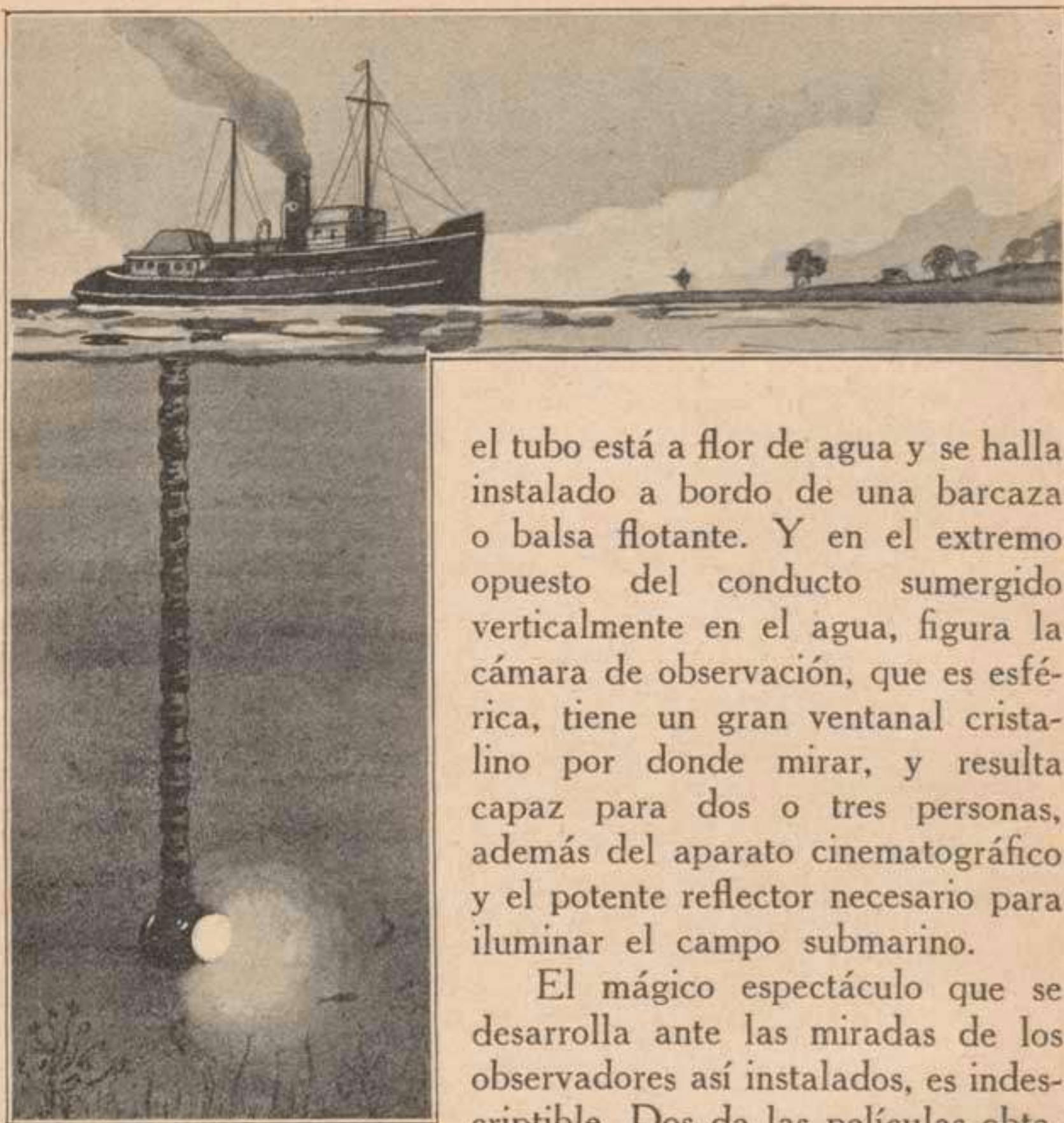
Esquema del aparato de los hermanos Williamson, para hacer fotografías en el fondo del mar
