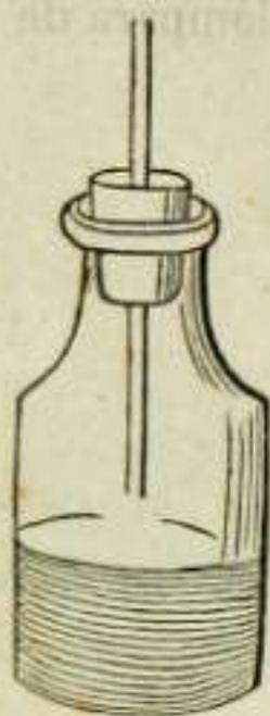
Sirve para lavar los precipitados reunidos en los filtros , y se emplea de este modo. Se introduce un poco de agua, se sopla por el extremo afilado para que entre un poco de aire. Con esto se produce una presión bastante fuerte en el líquido , y luego basta verter el frasco bruscamente para que salga un chorro de agua delgado y continuo con el cual se lavan los precipitados dirigiéndole contra ellos. Los filtros se lavan con otra botella de chorro en esta disposición.
