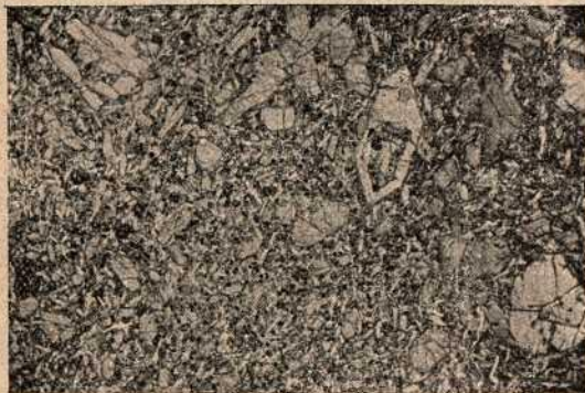
Fig. 40.— Basalto , visto al microscopio.
