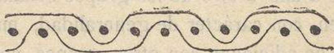
Perfil transversal del tejido doble cara por trama. Las tramas están representadas por las líneas, y la urdimbre por los puntos.
