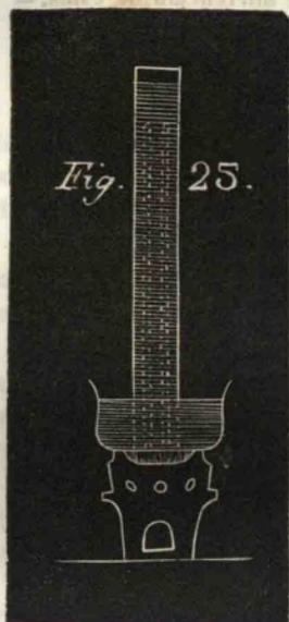
**Demostracion.** Si colocamos dos barómetros en una misma cubeta, y hacemos pasar á uno de ellos algunas gotas de éter, observaremos que tan luego como este líquido haya atravesado la columna de mercurio penetrado en el vacío barométrico, se evaporizará por lo menos en parte, y que la fuerza elástica del vapor espontánea é instantáneamente formado hará bajar la columna mercurial (figura 25).
