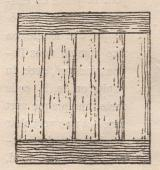
Si on plaque un couvercle de boîte de faible épaisseur, il est à craindre qu'il ne se voile; pour éviter ce grave inconvénient, le moyen le plus sûr est de plaquer l'intérieur en bois uni, en ayant soin d'appliquer le placage de manière à couper en travers la veine du bois de la monture.
