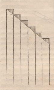
De même pour les angles des côtés d'une corbeille, après avoir tracé au compas (ou mieux au troussequin) une ligne qui détermine la partie à enlever, on peut superposer les 6 ou 8 pièces en avant soin de mettre chacune en retrait de la précédente, comme il est figuré ci-contre, puis d'un seul coup de lime ou mieux de rabot, on abat tous les angles; mais pour employer ce moyen, nous recommandons une grande précision dans le tracé.
