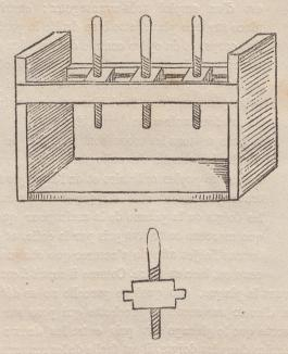
Les vis en bois sont supportées par des écrous également en bois et à queue qui glissent dans ces rainures et que l'on peut à volonté rapprocher ou éloigner.
