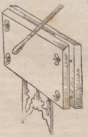
coupe inécessaire; il en est de même pour les tenons et les mortaises. On a soin, en découpant, de laisser le trou un peu petit, et c'est avec la lime que se fait l'ajustage.
