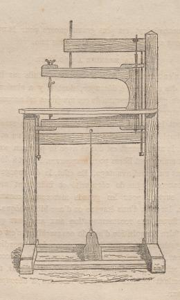
La distance de la scie au montant du châssis est de 0<sup>m</sup>43, ce qui permet d'exécuter des objets d'une certaine dimension; du reste, comme le châssis n'a qu'un côté, l'amateur intelligent trouvera toujours le moyen de tourner même dans une pièce très-grande (au besoin, les scies étant carrées, on les pince par côté).
