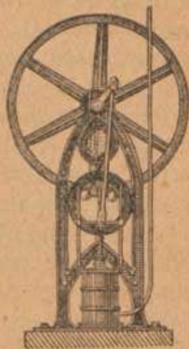
Transformación del movimiento de vaivén rectilíneo del émbolo de una máquina de vapor en el circular continuo del volante, mediante combinación de biela y manivela.
