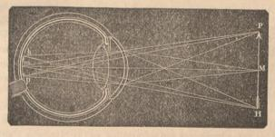
H M P Rayos luminosos que parten de un objeto.  $h\ m\ p$  Rayos luminosos refractados que pintan en la retina la imágen del objeto.
