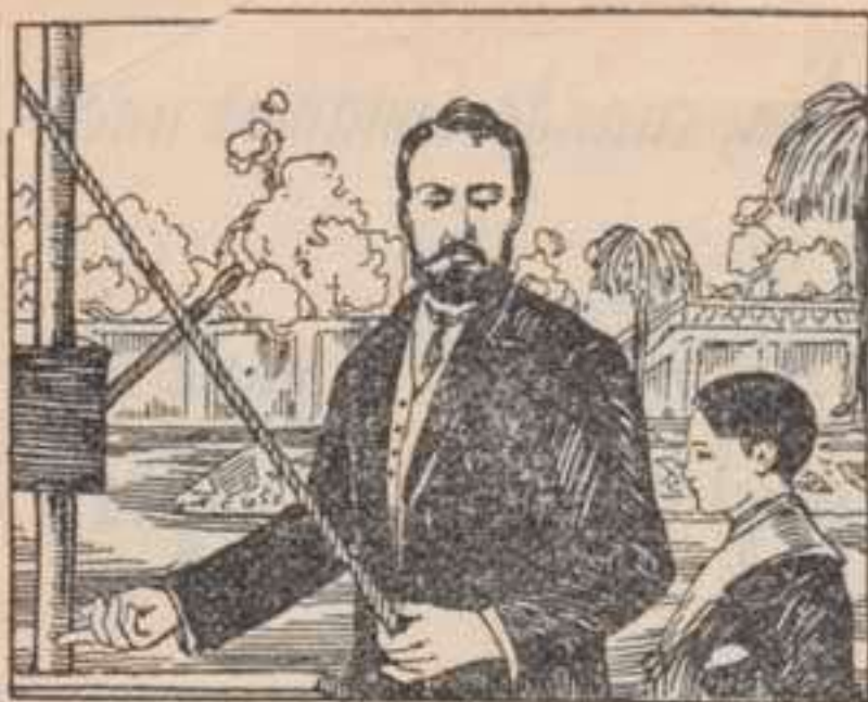
La presión atmosférica hace subir el agua por el tubo de la bomba
