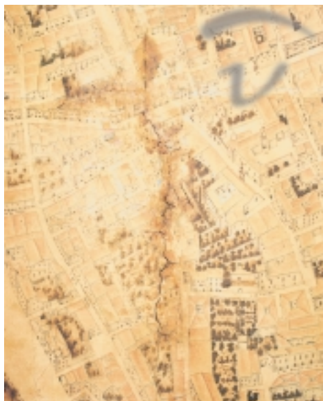
Figura 41.a- Rotura del soporte y manchas de humedad.
