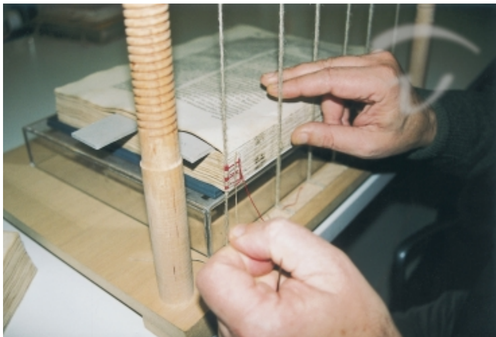
Figura 72.- Cosido de un libro del S. XVI y, al mismo tiempo, confeccionando las cabezadas.
