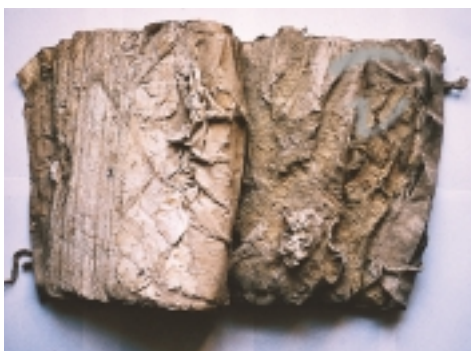
Figura 122.- Si el barro depositado en el material es espeso, es conveniente dejarlo secar y extraerlo mecánicamente.
