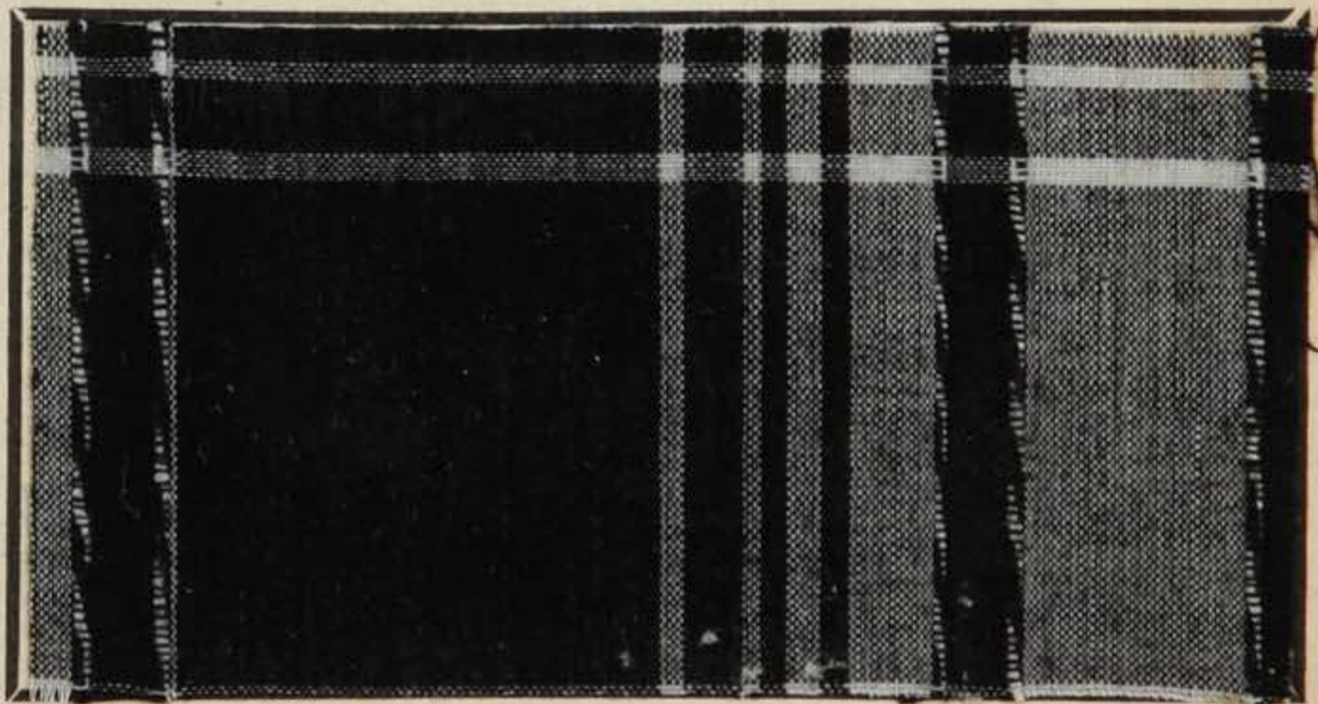
N° 414. Noir d'aniline teint en écheveau puis tissé avec blanc et couleur.
