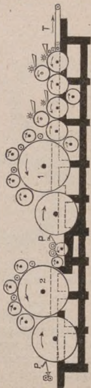
Fig. 190. — Schema di carda doppia, con avanzamento per pettinato.
