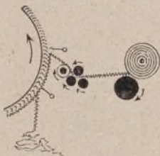
Fig. 22. — Carda a 1 solo pettine utile, contemporanea alla carda di Götze. — Il 2° pettine nettava il vano tra gli anelli. Cilindro separatore tra il pettinatore e i cilindri frotteurs .
