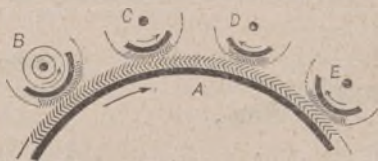
Fig. 27. — 4 modi differenti di azione di un cilindro su un tamburo.
