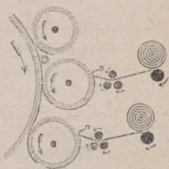
Fig. 20. — Schema di carda a 2 pettinatori con guernitura ad anelli per la divisione dei nastri (carda filatrice di Götze).
