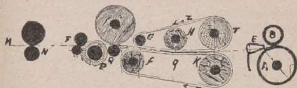
Fig. 218. — Caratteristiche del sistema frotteur in un bobinoir .
