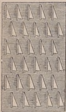
Fig. 69. — Tipo più semplice di ferri per guernire i cilindri alimentatori.
