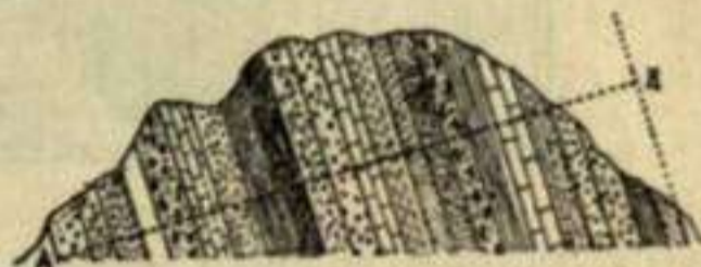
Fig. 114.—La Potencia o espesor de una serie de estratos se mide por la perpendicular (AB) a dichos estratos.
