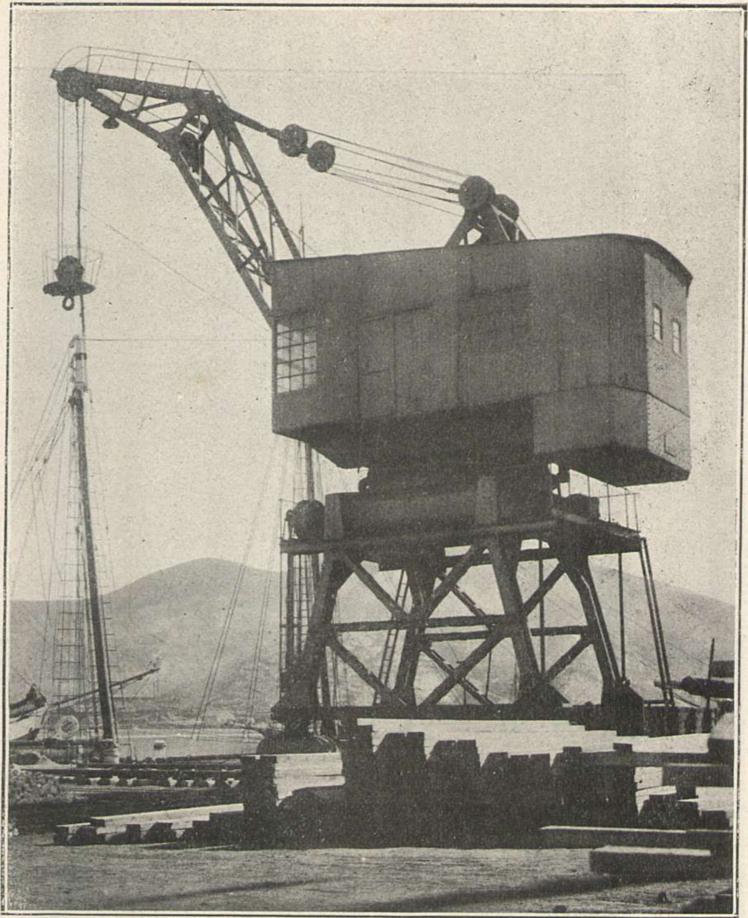
Una de las grúas eléctricas instaladas en 1927, en el Muelle Comercial, en sustitución de las de vapor. Potencia 20 toneladas.
