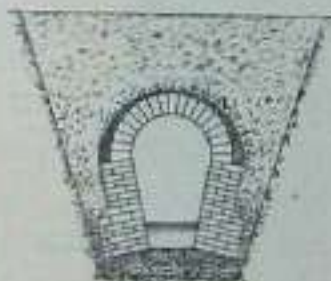
Sección del canal subterráneo
