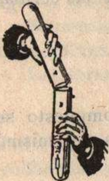
Fig. 14.—Trasvasar anh. carbónico.
