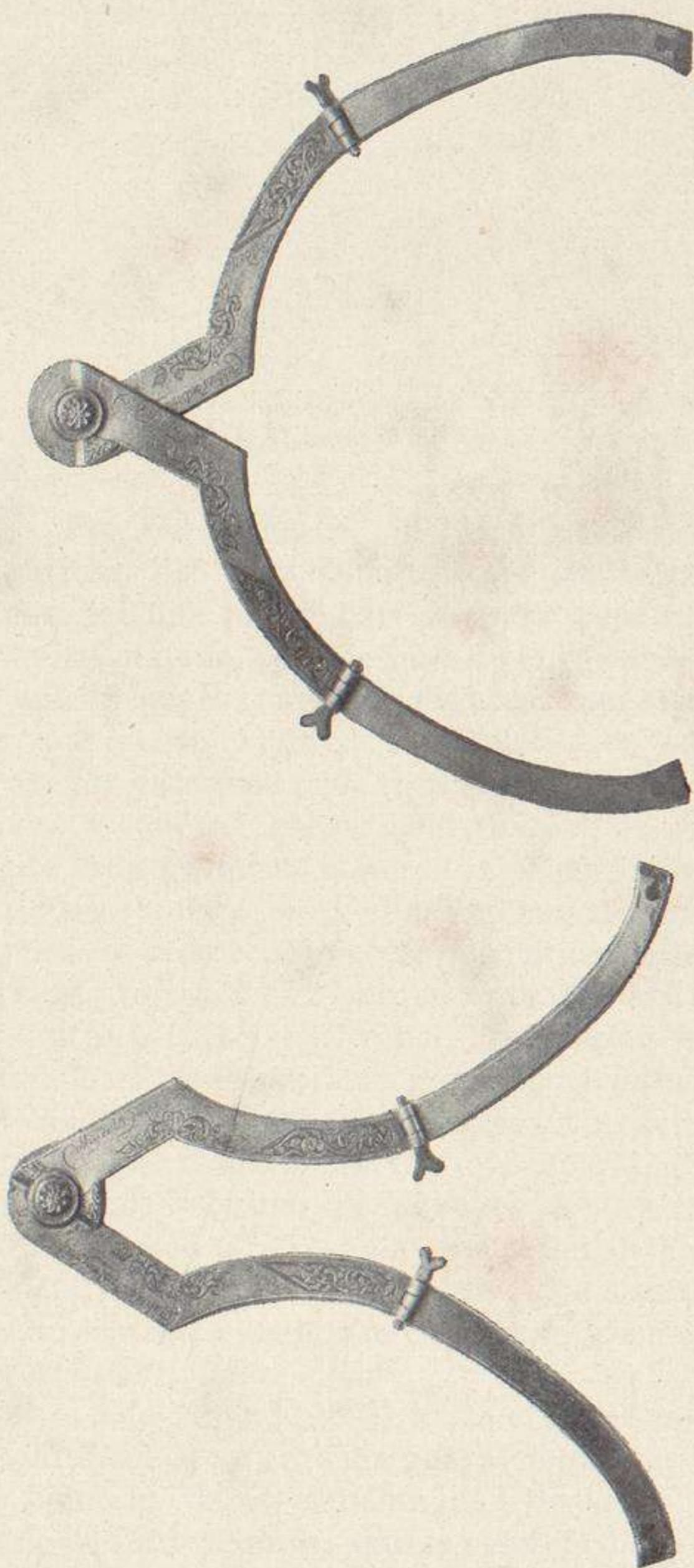
COMPÁS METÁLICO DE MEDIR EL CALIBRE DE LAS BOMBAS, GRANADAS Y CAÑONES
