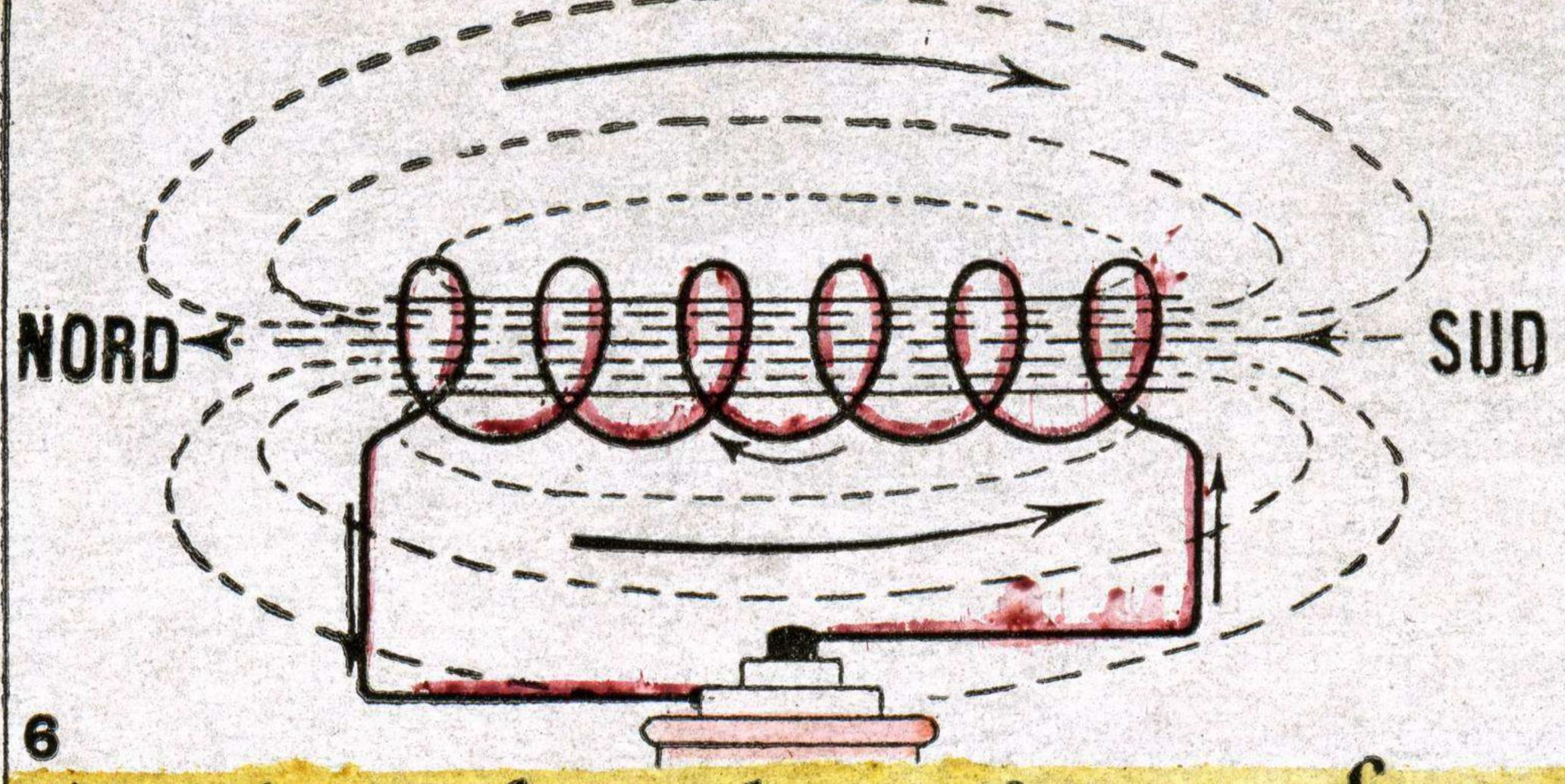
circulant dans les tubes de force du Pôle nord vers le Pôle sud Résistance magnétique ou RÉLUCTANCE
